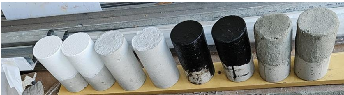
Figura 11 - Corpos de Prova Impermeabilizados.
