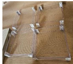
Figura 5 - Forma de Acrílico para teste de Estanqueidade.
